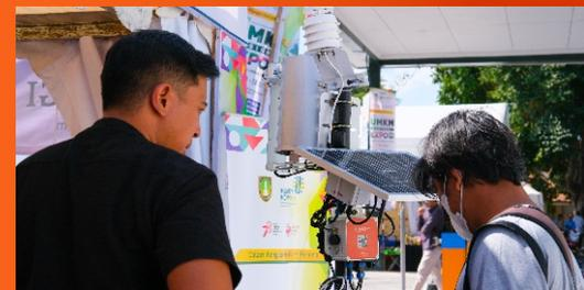
Automatic Water Level Recorder (AWLR) Mertani akan membantu anda dalam melakukan pemantauan tinggi muka air, baik tinggi muka air tanah (TMAT) maupun tinggi muka air saluran (TMAS).
